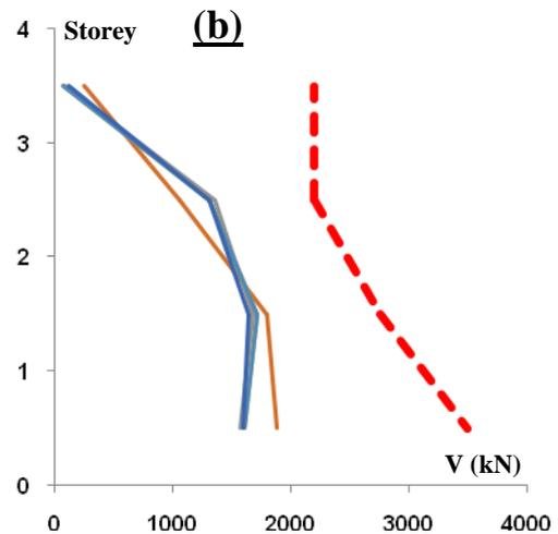
**Figure 15 (b)** Effort tranchant d'étage ( $V_{max}$ ) et résistance en cisaillement d'étage ( $V_n$ ) dans les éléments voiles en BA du bâtiment mixte de 4 étages pour la méthode en capacité
