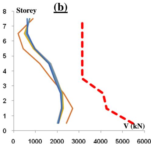
**Figure 16 (b)** Effort tranchant d'étage ( $V_{max}$ ) et résistance en cisaillement d'étage ( $V_n$ ) dans les éléments voiles en BA du bâtiment mixte de 8 étages pour la méthode en capacité
