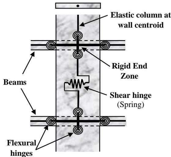
**Figure 6:** Représentation équivalente de l'élément poutre – poteau du voile en BA
