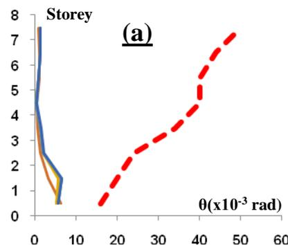
**Figure 19 (a)** Rotation maximale ( $\theta_{max}$ ) et rotation ultime ( $\theta_u$ ) dans les éléments voiles en BA du bâtiment de 8 étages pour la méthode conventionnelle
