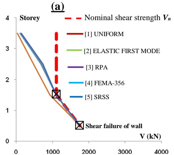
**Figure 15 (a)** Effort tranchant d'étage ( $V_{max}$ ) et résistance en cisaillement d'étage ( $V_n$ ) dans les éléments voiles en BA du bâtiment mixte de 4 étages pour la méthode conventionnelle
