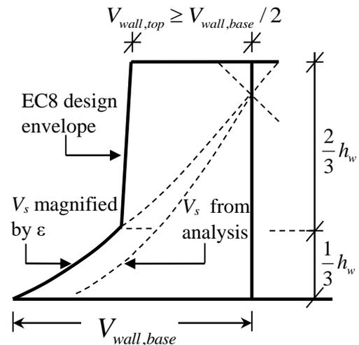
**Figure 2** : Enveloppe de dimensionnement en cisaillement des voiles en BA des structures mixtes selon l'EC8
