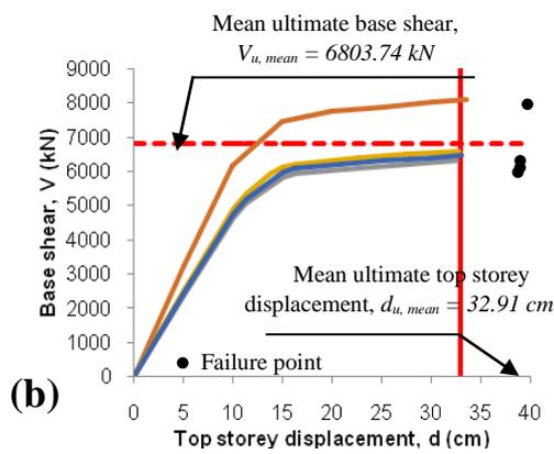
**Figure 8 :** Courbes de capacité du bâtiment mixte en BA de 4 étages dans les cinq modèles de charge pour: (a) méthode conventionnelle, (b) méthode en capacité
