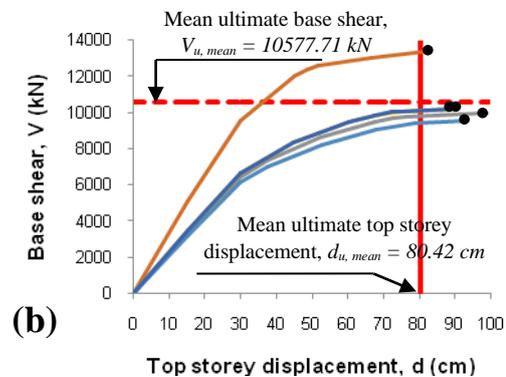
**Figure 10 :** Courbes de capacité du bâtiment mixte en BA de 12 étages dans les cinq modèles de charge pour: (a) méthode conventionnelle, (b) méthode en capacité
