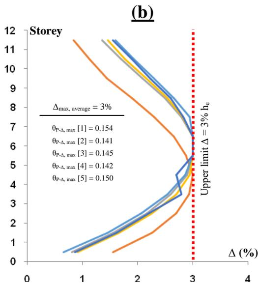
**Figure 14:** Déplacement inter-étages et coefficient de stabilité du bâtiment mixte de 12 étages pour (a) méthode conventionnelle et (b) méthode en capacité
