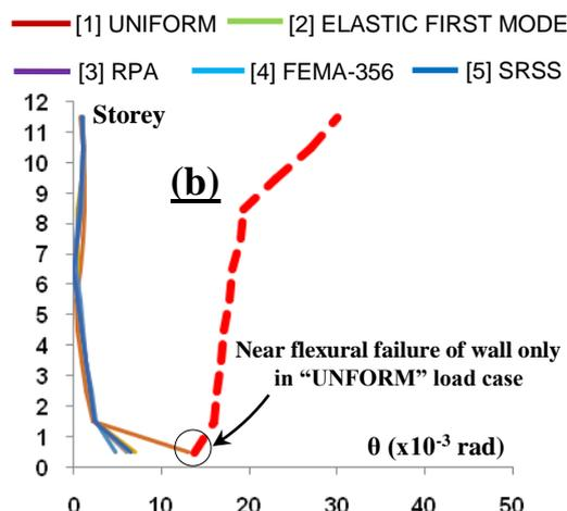
**Figure 20 (b)** Rotation maximale ( $\theta_{max}$ ) et rotation ultime ( $\theta_u$ ) dans les éléments voiles en BA du bâtiment de 12 étages pour la méthode en capacité
