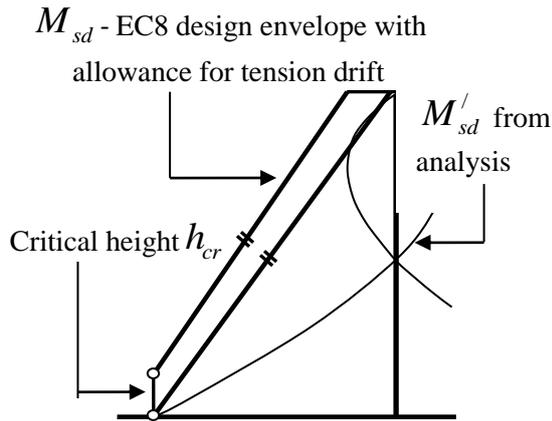
**Figure 1** : Diagramme typique des moments dans les voiles en BA des structures mixtes a partir de l'analyse et de l'enveloppe linéaire pour leur dimensionnement selon l'EC8
