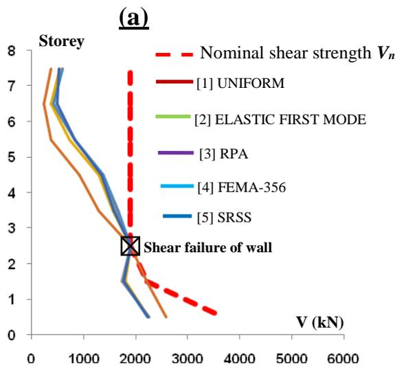
**Figure 16 (a)** Effort tranchant d'étage ( $V_{max}$ ) et résistance en cisaillement d'étage ( $V_n$ ) dans les éléments voiles en BA du bâtiment mixte de 8 étages pour la méthode conventionnelle
