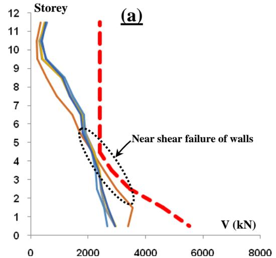
**Figure 17 (a)** Effort tranchant d'étage ( $V_{max}$ ) et résistance en cisaillement d'étage ( $V_n$ ) dans les éléments voiles en BA du bâtiment mixte de 12 étages pour la méthode conventionnelle
