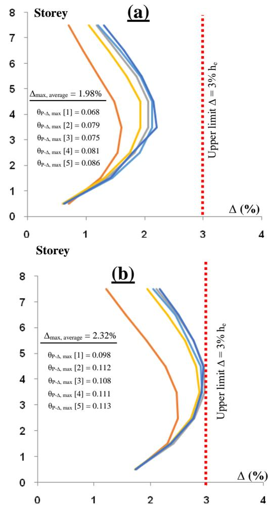
**Figure 13:** Déplacement inter-étages et coefficient de stabilité du bâtiment mixte de 8 étages pour (a) méthode conventionnelle et (b) méthode en capacité
