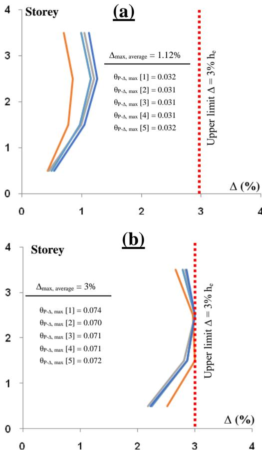
**Figure 12:** Déplacement inter-étages et coefficient de stabilité du bâtiment mixte de 4 étages pour (a) méthode conventionnelle et (b) méthode en capacité
