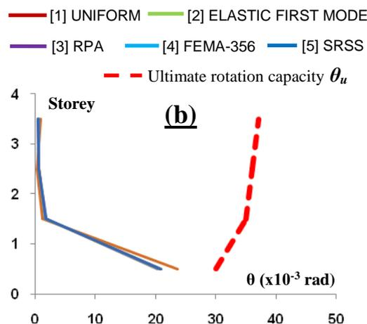
**Figure 18 (b)** Rotation maximale ( $\theta_{max}$ ) et rotation ultime ( $\theta_u$ ) dans les éléments voiles en BA du bâtiment de 4 étages pour la méthode en capacité
