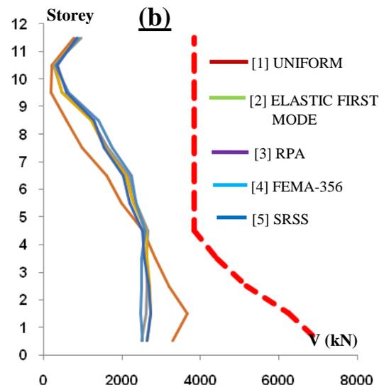
**Figure 17 (b)** Effort tranchant d'étage ( $V_{max}$ ) et résistance en cisaillement d'étage ( $V_n$ ) dans les éléments voiles en BA du bâtiment mixte de 12 étages pour la méthode en capacité
