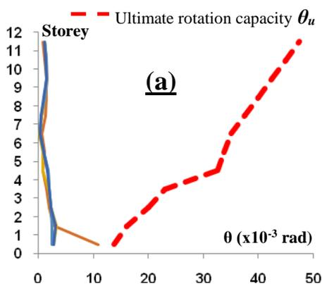
**Figure 20 (a)** Rotation maximale ( $\theta_{max}$ ) et rotation ultime ( $\theta_u$ ) dans les éléments voiles en BA du bâtiment de 12 étages pour la méthode conventionnelle
