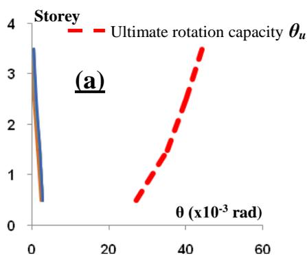
**Figure 18 (a)** Rotation maximale ( $\theta_{max}$ ) et rotation ultime ( $\theta_u$ ) dans les éléments voiles en BA du bâtiment de 4 étages pour la méthode conventionnelle
