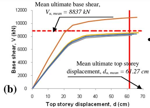
**Figure 9 :** Courbes de capacité du bâtiment mixte en BA de 8 étages dans les cinq modèles de charge pour: (a) méthode conventionnelle, (b) méthode en capacité
