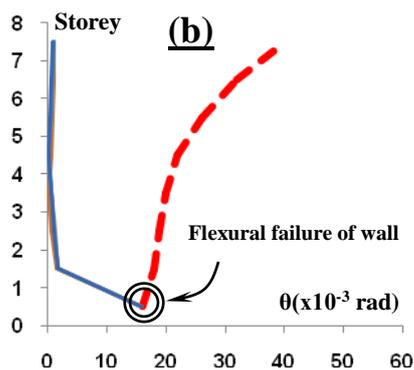
**Figure 19 (b)** Rotation maximale ( $\theta_{max}$ ) et rotation ultime ( $\theta_u$ ) dans les éléments voiles en BA du bâtiment de 8 étages pour la méthode en capacité
