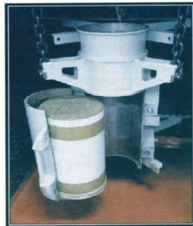
Figure 7 : Résultat du compactage (Armoire du VCPC) et retrait de l'éprouvette.
